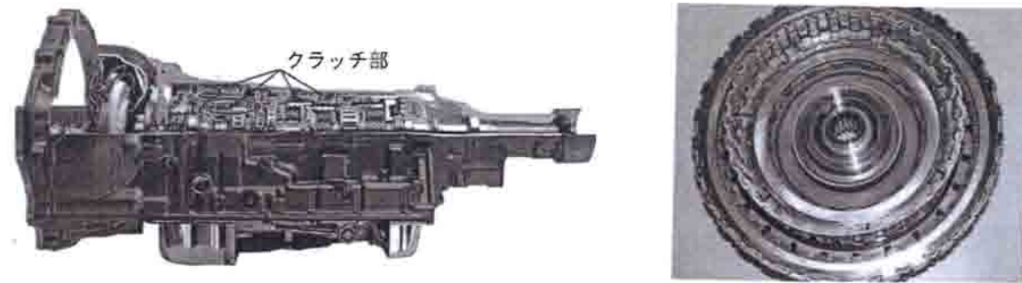
図1 AT車におけるクラッチドラム
