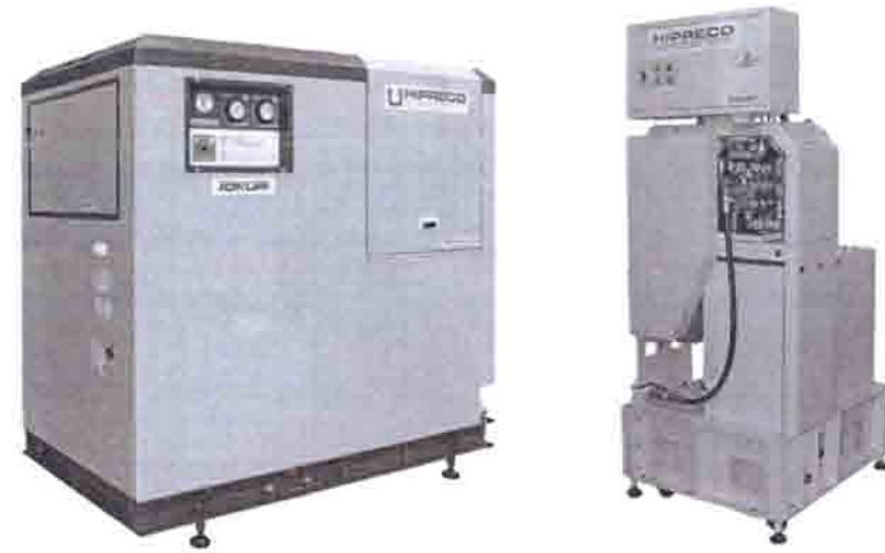
図7 超高压クーラント装置 (左、標準インバータ仕様・右、スマート仕様)
