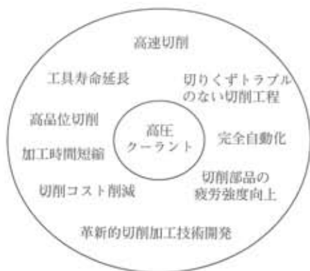
図1 高圧クーラントによりもたらされる良好な切削状態
