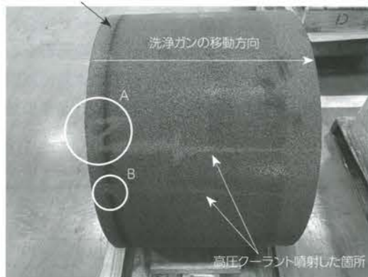
図4 高圧クーラント噴射後の砥石作業面(センタレス研削砥石)の状態
