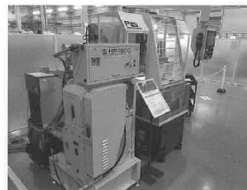
写真2 30MPaの超高压クーラント噴射ユニット
