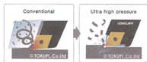
クーラントを超高压で加工ポイントに当てることで切りくずの分断をおこなう。切りくずを分断して絡みにくくするだけでなく、クーラントが的確に加工ポイントに当たることで、冷却効果も大幅にアップする。
