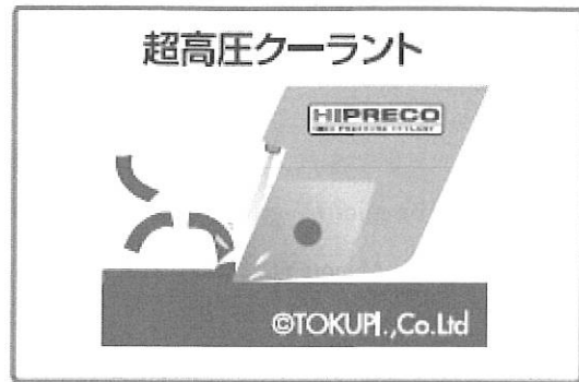
トクピの画期的技術、超高压クーラントの模式図(右)。切りくずを分断してからみにくくするだけでなく、クーラントが的確に加工ポイントに当たること、冷却効果も大幅アップ！ 航空業界はじめ、各業界から高い評価が寄せられています。
