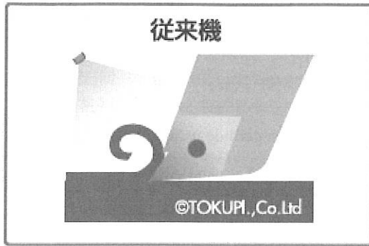
トクピの画期的技術、超高压クーラントの模式図(右)。切りくずを分断してからみにくくするだけでなく、クーラントが的確に加工ポイントに当たること、冷却効果も大幅アップ！ 航空業界はじめ、各業界から高い評価が寄せられています。
