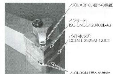
図2 クーラントの供給方法
