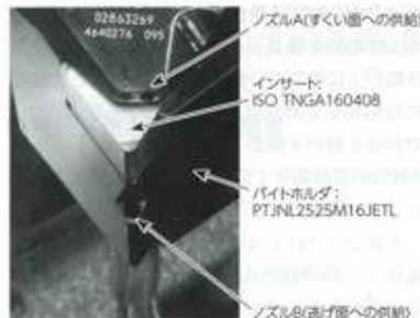
図5 クーラントの供給方法
