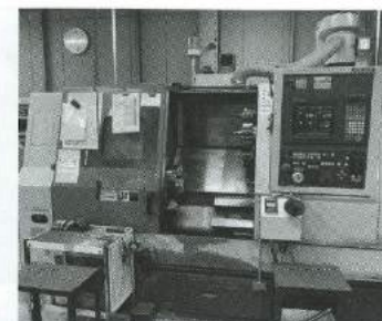
写真2 高圧クーラント供給切削で使用したCNC旋盤
