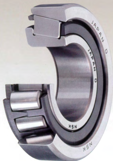
電動車用希薄潤滑環境向け円すいころ軸受 日本精工
