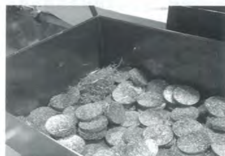
図12 圧縮した切りくず
