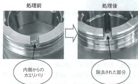
図11 高圧クーラントによるカエリバリの除去
