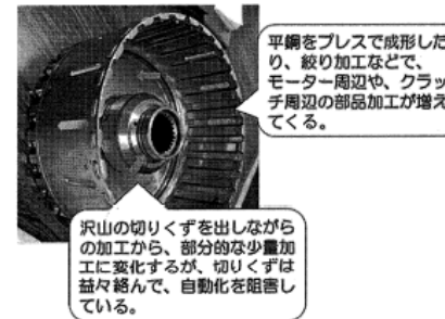
図4 SPCC・ss400材の切りくずトラブル
